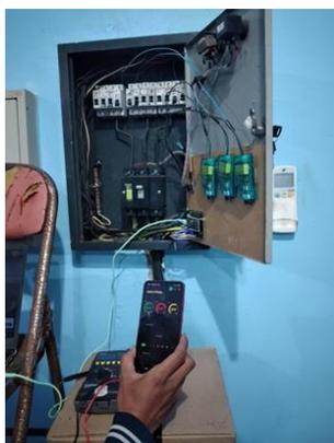
Gambar 1. Pengujian Perangkat Keras dan Dashboard Aplikasi *Blynk*
