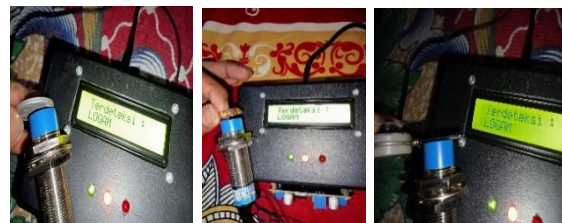
Gambar 10. Pengujian pada benda logam
