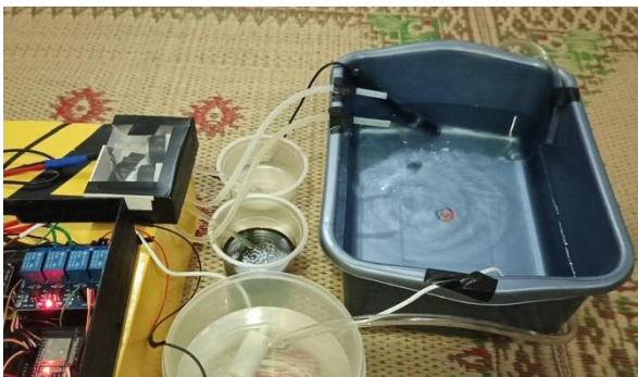
Gambar 6. Proses penambahan nutrisi oleh pompa peristaltik saat TDS berada di bawah acuan
